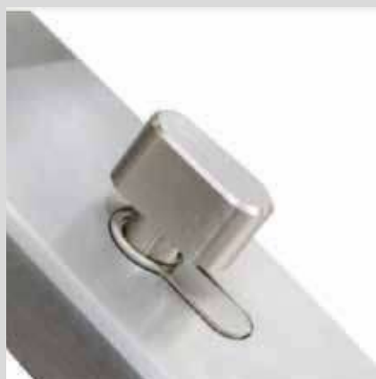
Verrou intérieur anti-panique. Se retire automatiquement lorsque la porte est ouverte de l'intérieur. Possibilité de configurer le déblocage via le logiciel.
